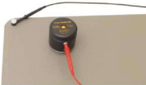
Messung des Oberflächenwiderstand  $R_s$
